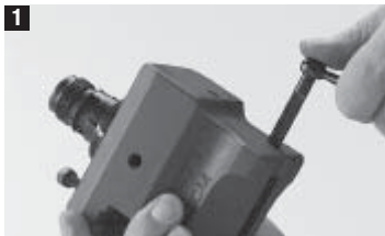
1 Osku so zaistovacou páčkou, ako je znázornené, vložte do vrtania a zatlačte až kým nezaskočí.
