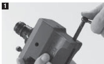
1 Podle obrázku nasadíte na úderový extraktor nový pryžový o-kroužek.
