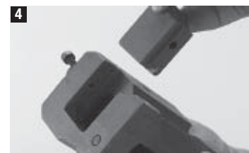
4 Одеть крышку. Закрепите фиксирующим винтом М6×30. Используйте специальный ключ.
