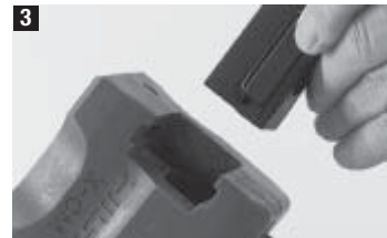
3 Absorbéry nasadte na úderník a vložte do raziacej hlavy, ako je znázornené.
