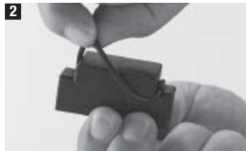
2 Namontujte nový gumový O-krúžok na úderník, ako je znázornené.
