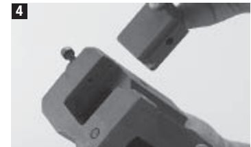
4 Uzáver nasadte do raziacej hlavy a zaistovacie skrutky (M6x30) pevne dotiahnite.
