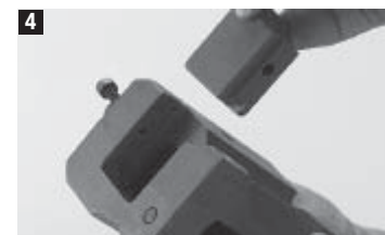
4 Zapah vstaviti v glavo za označevanje in vijake (M6x30) zavijačite.
