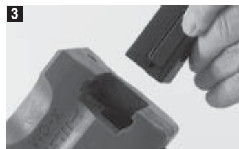
3 Po vložení úderového extraktoru vložte do hlavy tlumiče, jak je uvedeno na obrázku.
