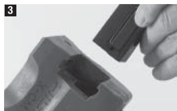
3 Dušilko vstaviti v udarni element in vse skupaj vstaviti v glavo za označevanje.
