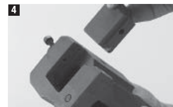
4 Přiložte na sebe horní a dolní kryt hlavy, sešroubujte čtyřmi zajišťovacími šrouby, M6x30 a zakápněte zajišťovacím lakem.
