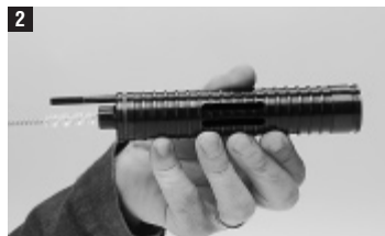
Interno caricatore propulsori
