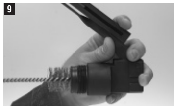
Чистка внутренней части опорной пластины.
