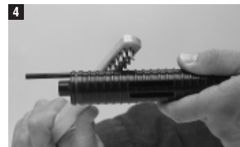
Наружная чистка направляющей поршня.
