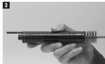
Чистка внутренней части направляющей поршня.
